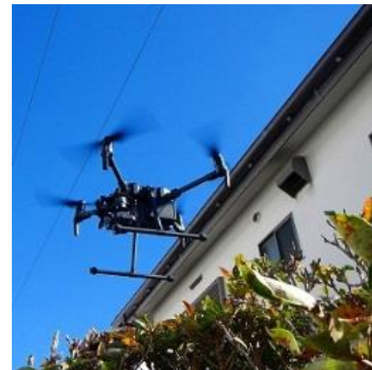
UAVsを活用した外壁点検業務
